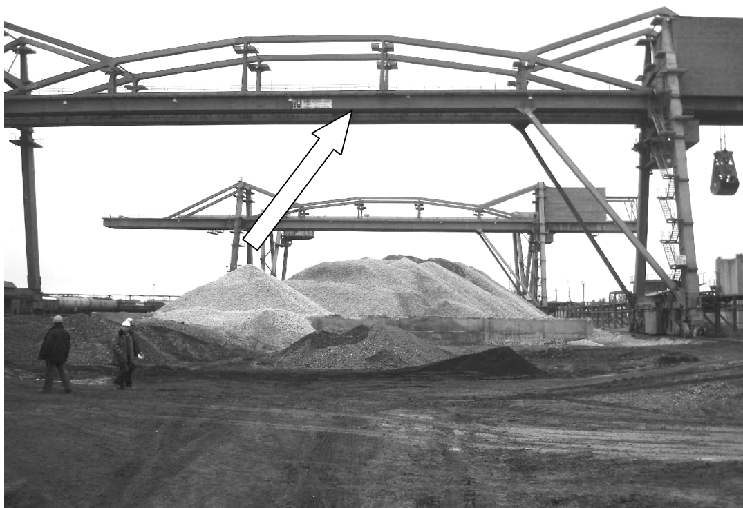
Рис. 2. Расположение конструктивного концентратора напряжений на рудно-грейферном перегружателе
